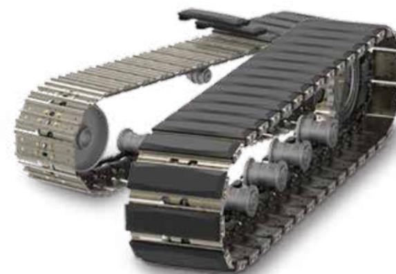
主にシュープレートにゴムパット取り付け用の穴が空いていない場合に使用します。片側フック/ボルト止めタイプと、両側ボルト止めタイプの2種類ございます。取付機種により取付金具が変わります。
